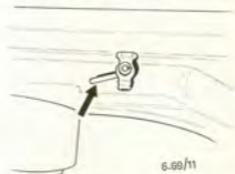
Afb. 29 Aftapkraan radiator via de drie eerdergenoemde aftapkranen waarbij tevens de knop van
