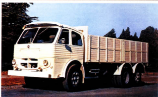
La tractora de tres ejes Pegaso 2045, con las dos primeras directrices, tuvo una difusión escasísima. El 1064 era un 1061 L con el chasis alargado poco más de un metro, para poder dotarle de un tercer eje.
