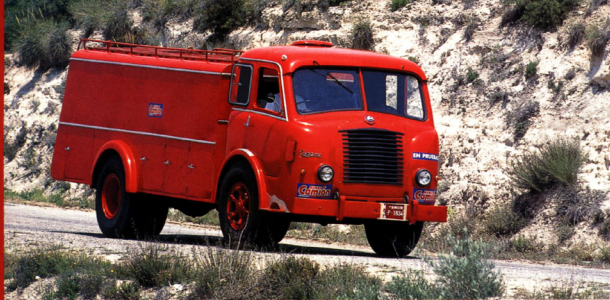
Pegaso Diesel 140 CV carrozado como autobomba, posterior a 1954 (las puertas abren de atrás hacia delante), propiedad del Centro Histórico Pegaso.
