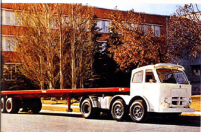
La tractora de tres ejes Pegaso 2045, con las dos primeras directrices, tuvo una difusión escasísima. El 1064 era un 1061 L con el chasis alargado poco más de un metro, para poder dotarle de un tercer eje.
